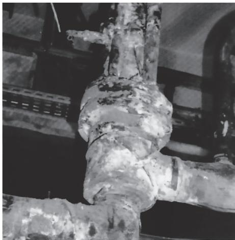
写真 2：ナトリウム漏洩後のフェニックスのバルブ，
